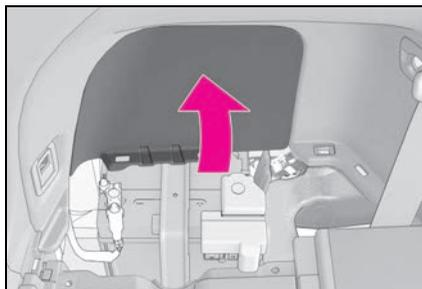
**2** Instale a tampa da bateria de 12 volts.
