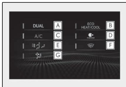
**A** Ajusta a temperatura dos bancos do motorista e dos passageiros separadamente (modo "DUAL") (→P.343)
