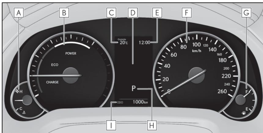
**A** Medidor de temperatura do líquido de arrefecimento do motor
