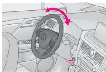
● Para evitar o superaquecimento do motor de travamento da direção, o funcionamento do motor poderá cessar caso o sistema híbrido seja ligado e desligado repetidamente durante um curto período. Nesse caso, evite operar o sistema híbrido. Após aproximadamente 10 segundos, o motor de travamento da direção irá retomar o funcionamento.
