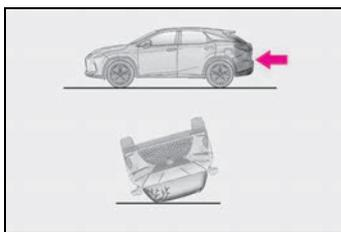
Veículos com sistema de classificação do passageiro dianteiro: Os sistemas de airbag de cortina, em geral, não deflagram se o veículo sofrer uma colisão traseira, se ele capotar de frente, ou ainda em caso de colisão frontal ou lateral em baixa velocidade.
