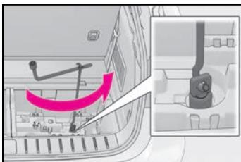
Se o pneu reserva ainda não puder ser abaixado, o cabo elétrico pode estar rompido. Providencie a inspeção do veículo em uma Concessionária Autorizada Lexus.
