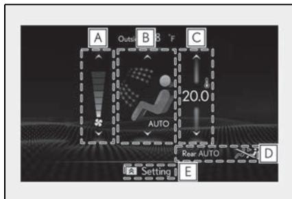
**A** Ajustar a regulagem de velocidade do ventilador dos bancos traseiros
