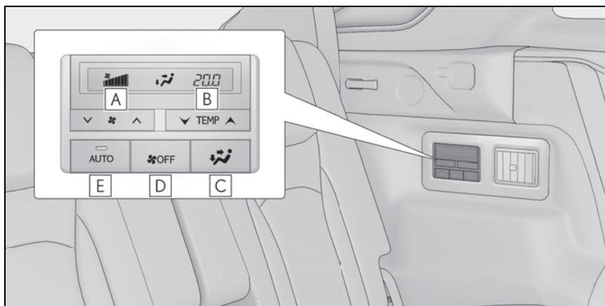
**A** Ajustar a regulagem de velocidade do ventilador dos bancos traseiros
