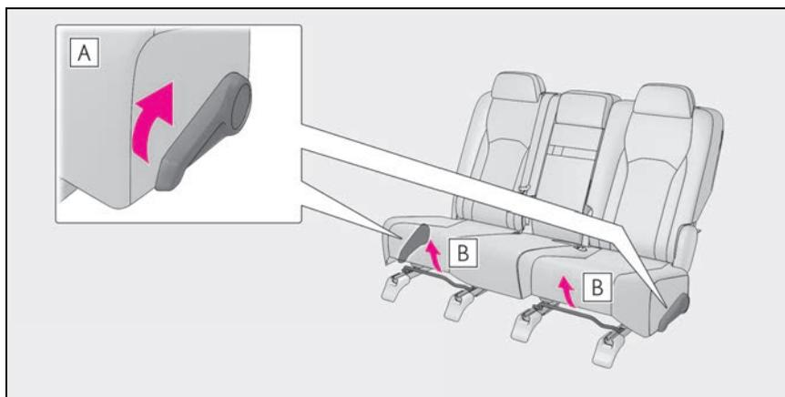
**A** Alavanca de ajuste do ângulo do encosto do banco**B** Alavanca de ajuste da posição do banco
