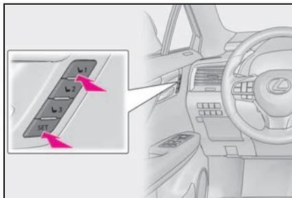
Veículos com a memória da posição de condução para o banco do passageiro dianteiro: Para registrar a posição do banco do passageiro dianteiro, ajuste o banco do passageiro dianteiro para a posição desejada e execute a etapa 4 usando os botões da lateral do passageiro dianteiro.
