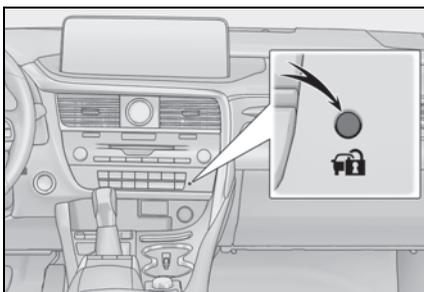
A luz indicadora pisca após o desligamento do botão de partida, indicando que o sistema está funcionando.
