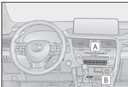
**A** Sistema de ar-condicionado automático dianteiro (→P.339)
