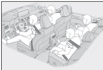
Os pré-tensionadores possibilita uma maior proteção dos ocupantes ao retrair rapidamente o cinto de segurança quando o veículo é submetido a determinados tipos de colisão frontal ou lateral grave.
