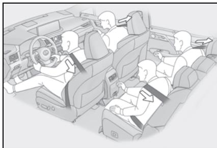
Os pré-tensionadores possibilita uma maior proteção dos ocupantes ao retrair rapidamente o cinto de segurança quando o veículo é submetido a determinados tipos de colisão frontal ou lateral grave, ou ainda, em um capotamento do veículo.
