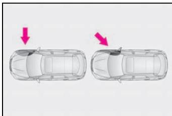
Veículos sem sistema de classificação do passageiro dianteiro: Os airbags de cortina, em geral, não deflagram se o veículo for envolvido em uma colisão traseira, se capotar, ou ainda em caso de colisão lateral em baixa velocidade ou colisão frontal em baixa velocidade.
