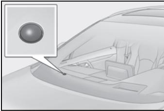
O sensor poderá não funcionar corretamente se um objeto for posicionado sobre o sensor, ou se algum objeto for fixado no para-brisa, causando obstrução do sensor. Isto irá interferir na capacidade do sensor em detectar o nível da luz ambiente e poderá resultar em uma falha no sistema automático dos faróis.
